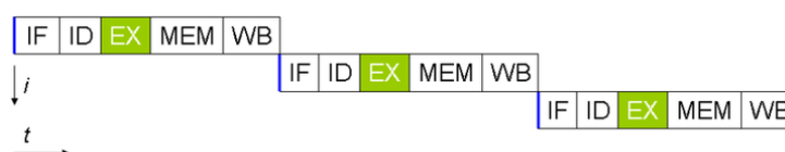
Rysunek 3.3: Schemat przetwarzania bez wykorzystania współbieżności [źródło: Wikipedia]
