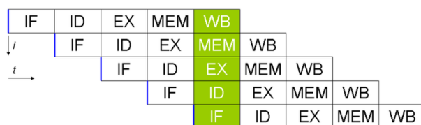
Rysunek 3.4: Schemat klasycznego przetwarzania potokowego [źródło: Wikipedia]
